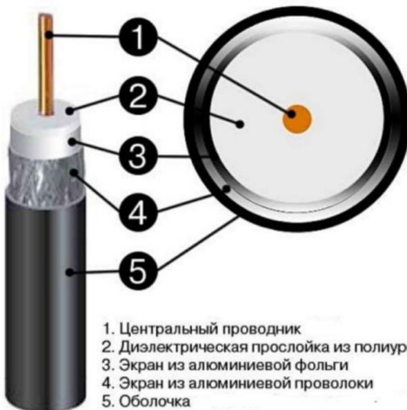
**Важно, чтобы центральная жила не соединялась ни с одним из проводов оплётки – это может привести к короткому замыканию и отсутствию видеосигнала.**
