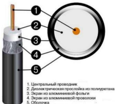
Не забудьте перед началом разделки надеть на кабель защитный колпачок от BNC-разъема.
